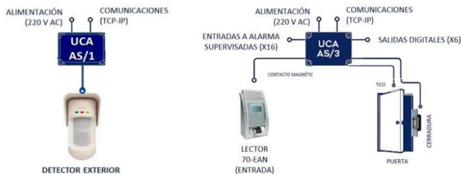
Figura 31. Equipamiento Sistema Control de Acceso y Anti-Intrusión
