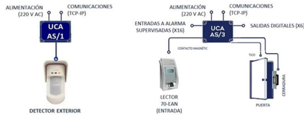
Figura No. 75 Equipamiento Sistema Control de Acceso y Anti-Intrusión
